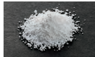
ポリフェニレンサルファイド(PPS) 機械強度、耐熱性、耐薬品性、難燃性に優れ、スーパー・エンジニアリング・プラスチックとして世界中で高く評価されています。
