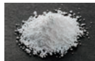
ポリフェニレンサルファイド(PPS) 機械強度、耐熱性、耐薬品性、難燃性に優れ、スーパー・エンジニアリング・プラスチックとして世界中で高く評価されています。
